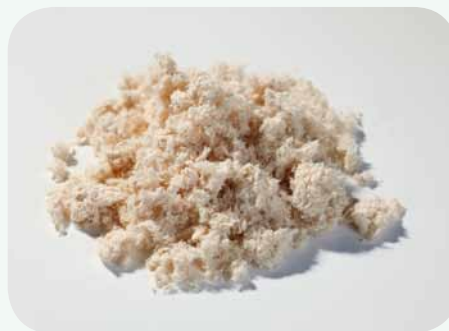
Zerfaserner Holzstoff nach dem Refiner
