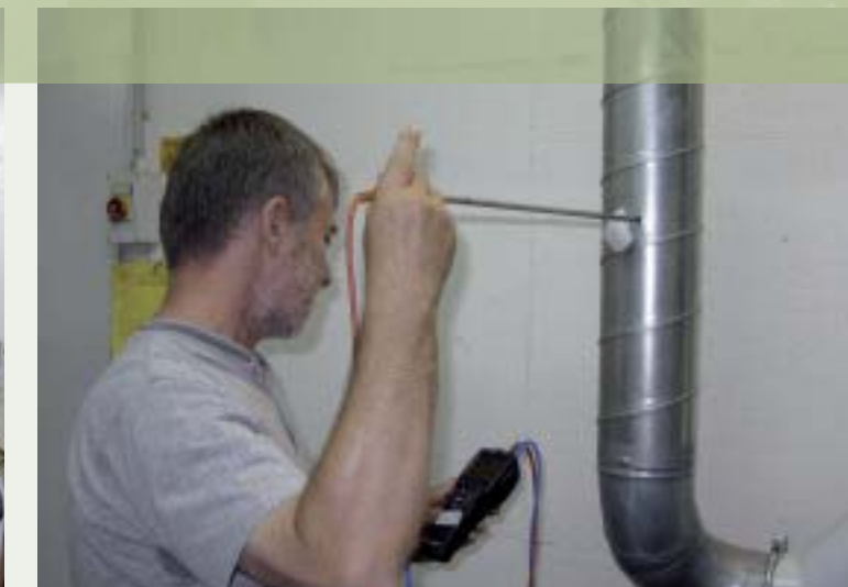
Prüftechniker bei der Online-Messung der Schadstoffe
